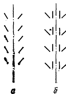
Рис. 4. Гипотетическое распределение молекул с сохранением цилиндрической симметрии и одного и того же параметра S : а — дисперсия отсутствует; б — дисперсия имеет место
